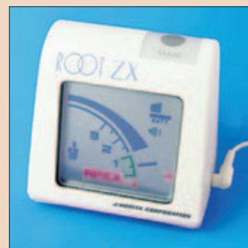
Das vollautomatische Endometriegerät Root ZX von Morita. Der speziell für das ROOT ZX entwickelte Mikroprozessor fasst alle Gerätefunktionen, die für das Ausmessen von Wurzelkanälen erforderlich sind, in einem Chip zusammen.
